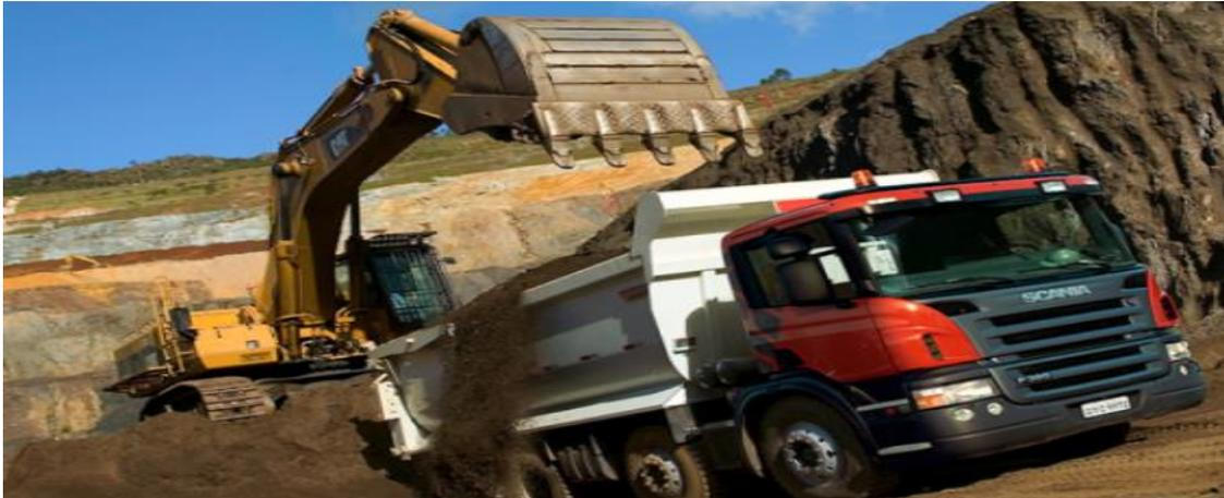
Equipo diseñado y construido para ser operado por medio de camión 8x4, con el propósito de transportar rocas de primera explosión.
